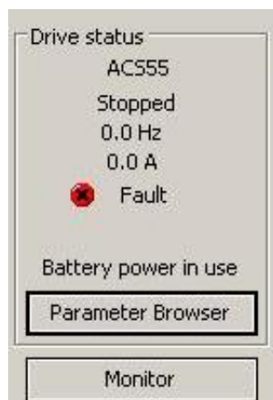
Obrázek 10. Stav měniče, když je napájen z akumulátoru
